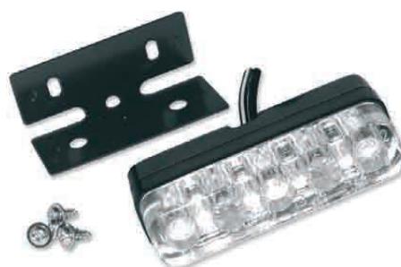
Ref. 9917 Luz de matrícula trasera universal a Leds. 12V 0.2W. E-Mark: E11-50R-00 1062 37x9 mm. Con tornillos y adhesivo.
